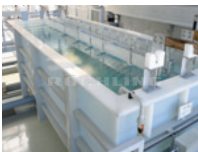
Polystone® P omopolimero naturale Vasca anodica per il trattamento di maniglie
