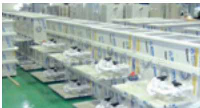
Polystone® P Homopolymer grau Behälter für eine Kupferbeschichtungsanlage
