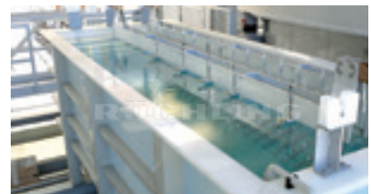
Polystone® P Homopolymer natur Eloxalbecken zur Behandlung von Türgriffen
