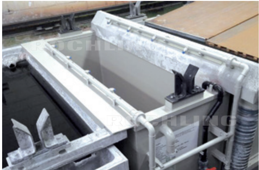
Schnelle Fertigung: Spülwasserbehälter aus Polystone® P CubX® ohne Stahlverstärkungen
