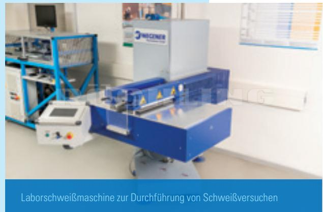
Laborschweißmaschine zur Durchführung von Schweißversuchen
