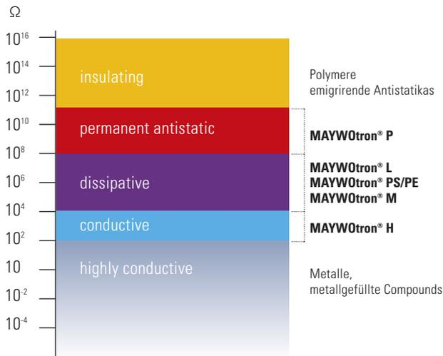
Elektrische Felder können durch äußere Entladung, z.B. durch Berührung durch einen aufgeladenen Körper, aber auch durch das Handling (Reibungsenergie) entstehen.
