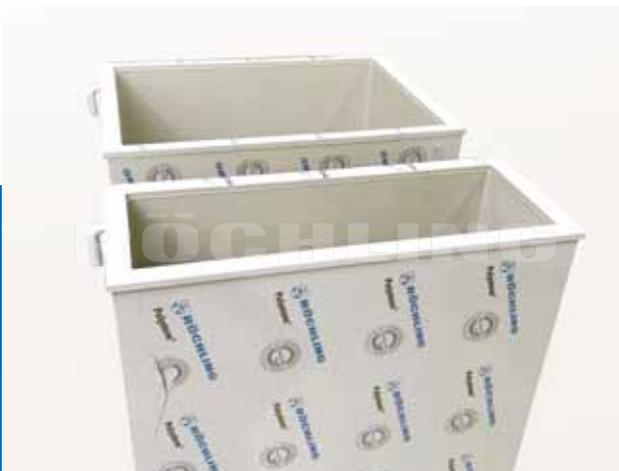
**Schnelle Fertigung:** Zwei Spülwasserbehälter aus Polystone® P CubX® für eine Eloxal-Anlage. Mit Polystone® P CubX® war ein vollständiger Verzicht auf Stahlverstärkungen und die damit verbundenen zeitaufwendigen Schweißarbeiten möglich
