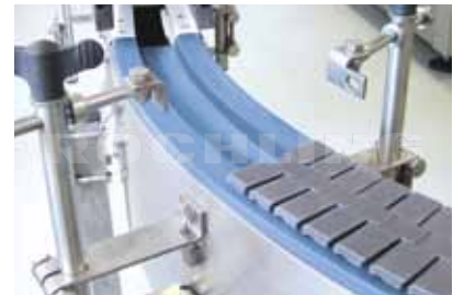
POM Transportkette auf LubX® C POM transport chain on LubX® C
