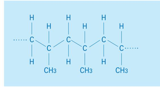
Estructura molecular de un polipropileno isotáctico
