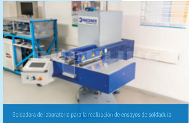
Soldadora de laboratorio para la realización de ensayos de soldadura.
