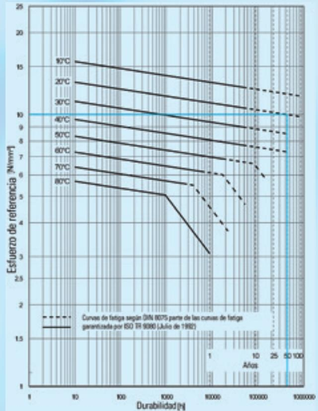
Requisitos para un PE 100 mostrados en base a las curvas de fatiga de la DVS 2205 parte 1. A una temperatura de trabajo de 20 °C, un PE 100 debe conservar una resistencia mínima de 10 N/mm<sup>2</sup> después de 50 años de uso.
