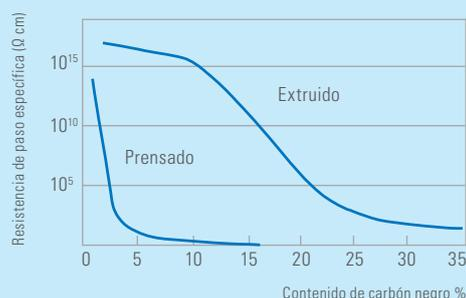
Resistencia de paso específica en función de la concentración de carbón negro
